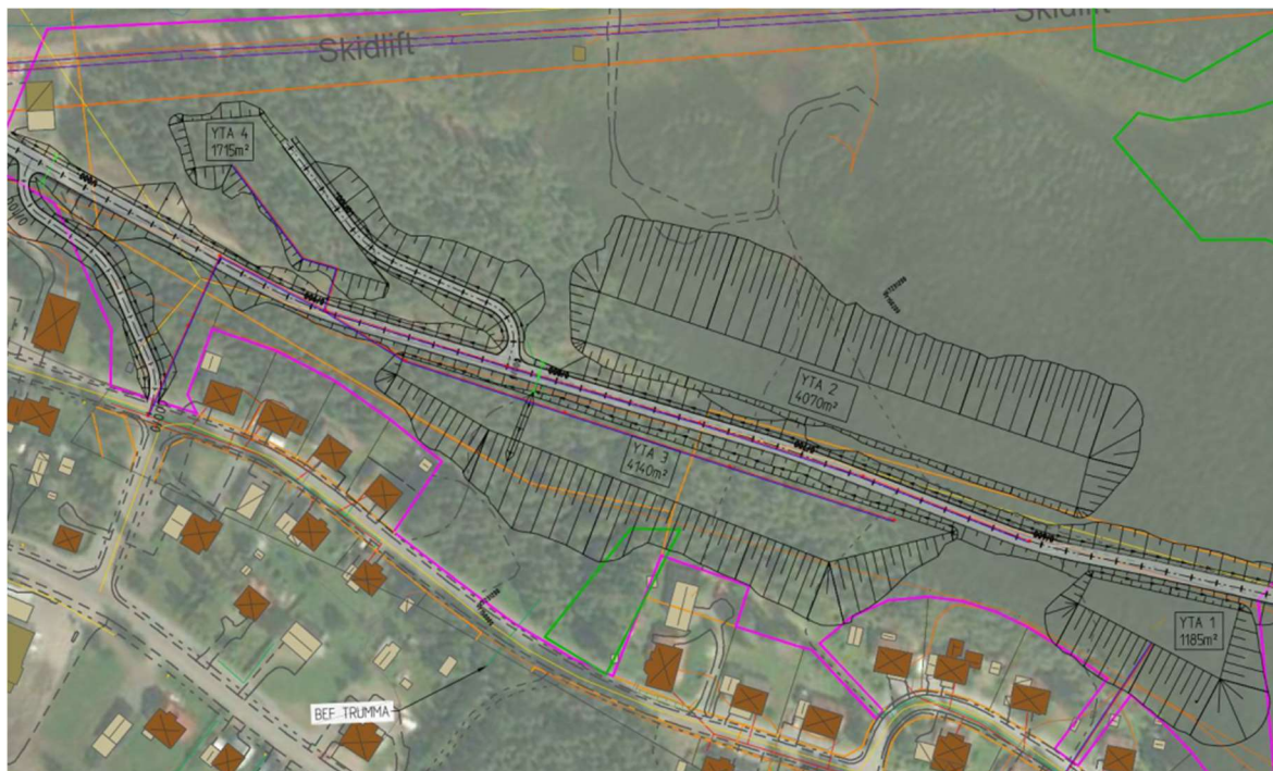
Figur 27: Urklipp från vägprojekteringen där föreslagen sträckning för nytt VA redovisas i röda linjer för spillvatten och blå linjer för dricksvatten. Bild från PM Dagvatten (Sweco Sverige, 2025).
