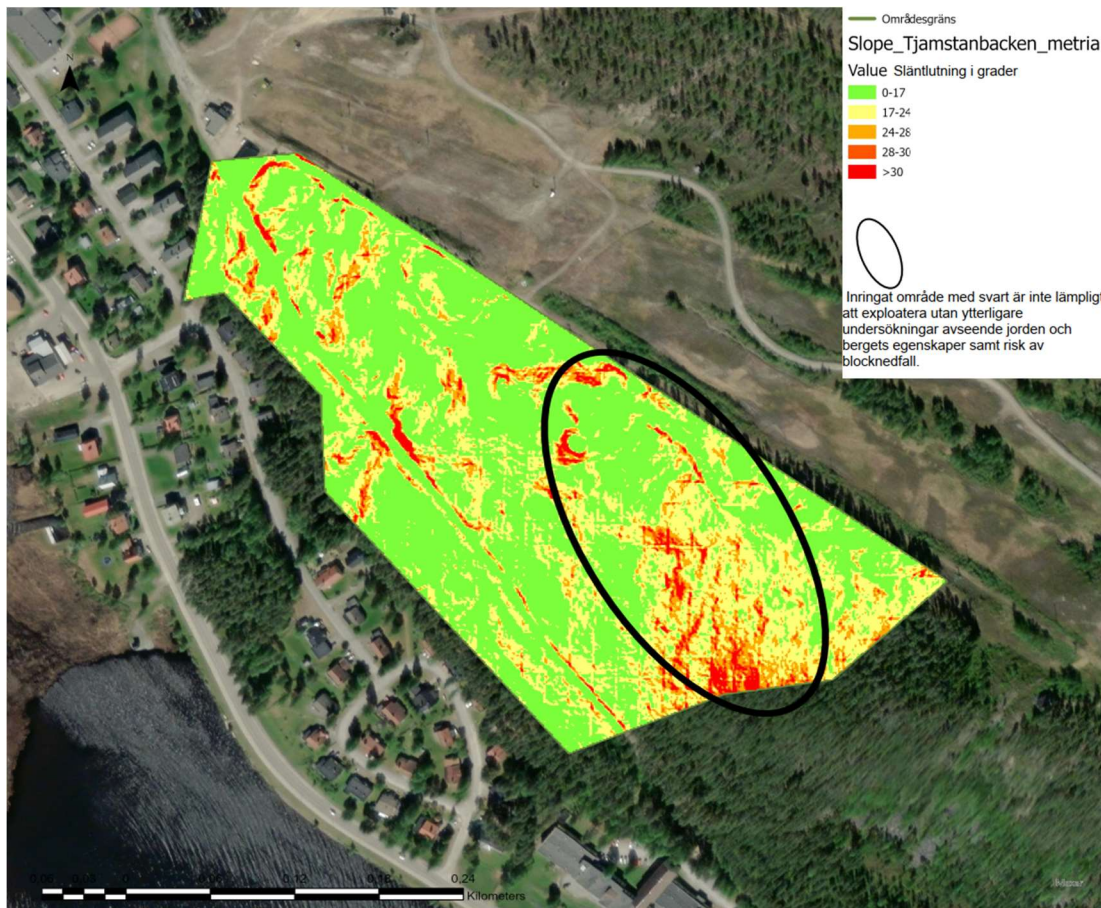
Figur 24. Släntlutning inom planområdet. Höjddata erhållet från nationella höjddatabasen (SWEREF 99 18 45, RH200). Område inringat med svart är inte lämpligt att exploatera utan ytterligare undersökningar. Bild från den geotekniska utredningen (Tyréns, 2023).
